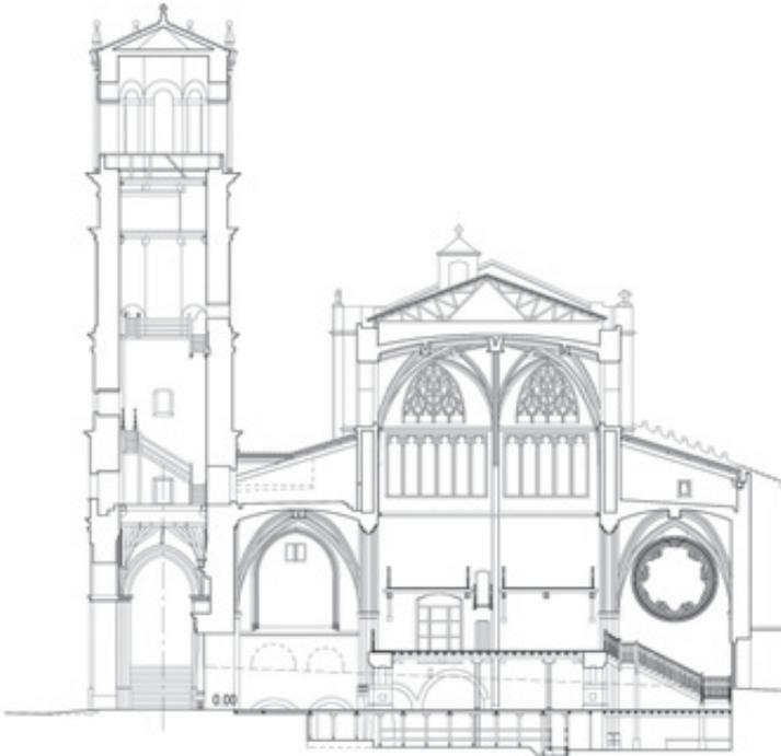
Fig. 16: San Salvador de Getaria: Sección transversal del templo por la torre. Por eso no se ve ningún arbotante. Las ventanas del claristorio están sin dibujar. El hueco bajo el entarimado del templo indica el nivel del suelo originalmente previsto. Algunos pilares hunden todavía hoy sus basas hasta allí abajo. La altura de ese sótano viene a coincidir con lo que creció el triforio.
