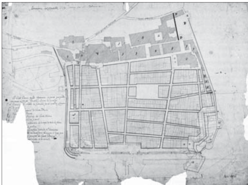
Ilustración 14: Planta del PLAN DE SÍNTESIS FINAL (10.4). Es el de GOGORZA dibujado y corregido por Ugartemendía. Año 1816. La delineación, en tinta negra, se superpone a la traza antigua, en aguada amarillenta. A partir de este plano se reconstruyó San Sebastián.
