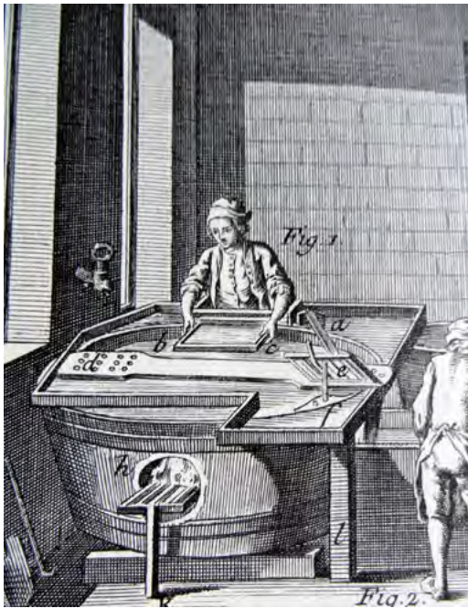
[Figs. 37 y 38] Grabados. Método de fabricar el papel y grabado de “la forma”.
